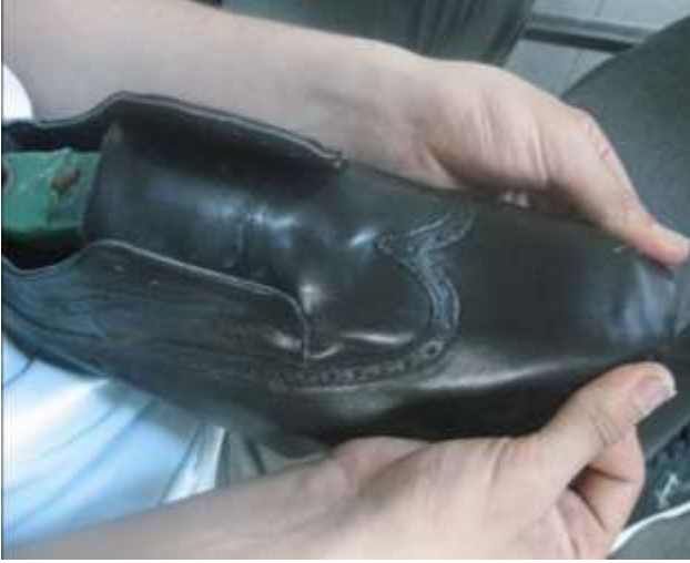
Resim 7: Sayanın Kalıba Yerleştirilmesi
