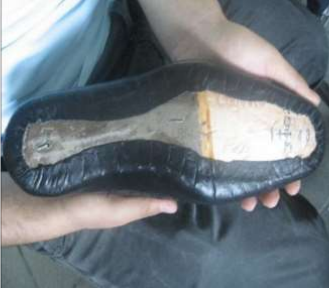
Resim 9: Çivilerin kalıptan sökülmüş hâli
