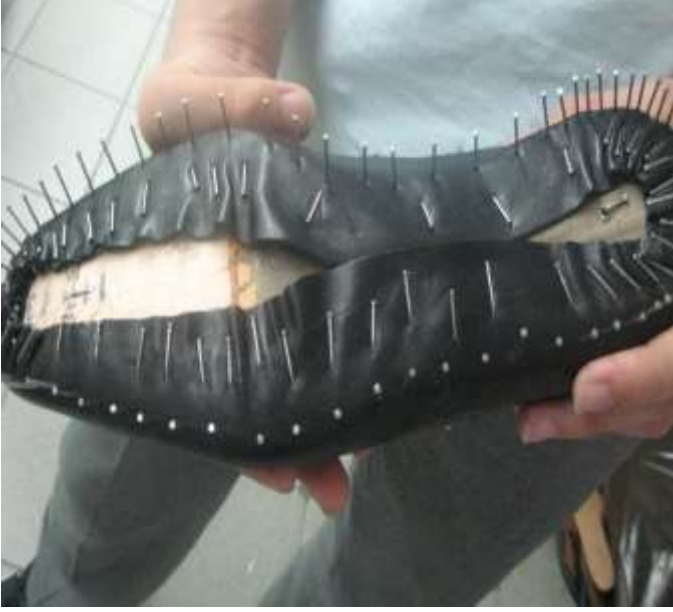
Resim 8: Kalıba çivi dizilmesi işleminin yapılması
